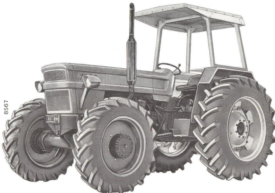
Le tracteur **Mod. 1000 DT super** est pourvu de quatre roues motrices au lieu des roues arrière seulement. Le pont avant, équipé d'un différentiel, est entraîné par la boîte de vitesses par l'intermédiaire de pignons de renvoi et d'un arbre de transmission.
