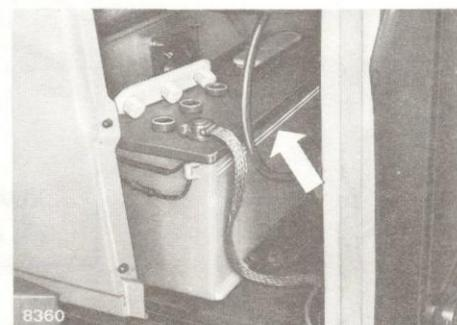
**10 BATTERIE** - Moteur arrêté, tracteur à plat et batterie reposée et froide, vérifier le niveau de l'électrolyte (voir page 42 de la Notice).
