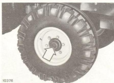
**27 MOYEUX DE ROUES AVANT** - Dévisser les couvercles des moyeux, les remplir de graisse Fiat G9 et les remonter.
