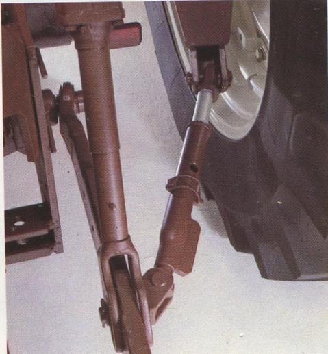
Raccords pour distributeurs auxiliaires et freinage hydraulique de remorque
