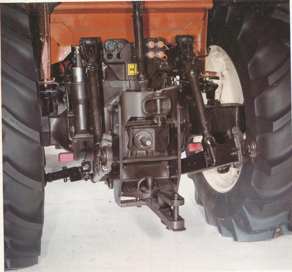
**Relevage hydraulique** à effort et position contrôlés et contrôle mixte, attelage 3 points cat. 2 (cat. 3 en option) avec un nouveau système du contrôle d'effort (barre de flexion à bain d'huile à commande intérieure). Actionné par deux leviers aux lignes nouvelles et particulièrement accessibles, la mise en place de l'outil est immédiate.
