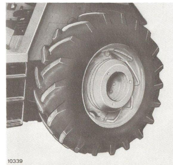
motrices peuvent patiner par insuffisance d'adhérence au sol, provoquant des pertes de puissance et de vitesse, une consommation de combustible plus importante et une usure des pneumatiques.
