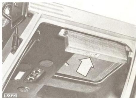
**FILTRE A AIR EN PAPIER** - Dévisser les pommeaux, déposer les cartouches (une par côté) et les nettoyer:
