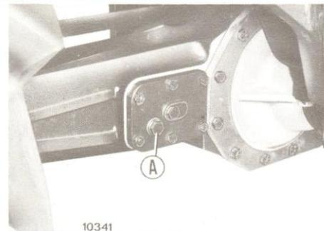
**28 CARTER DE PONT AVANT (DT)** - Vérifier que l'huile arrive au bouchon A; si nécessaire, faire l'appoint par ce même bouchon (voir « Approvisionnements »).
