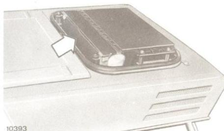
**FILTRE A AIR DE RECYCLAGE** - Déposer le capot supérieur, extraire le filtre et le nettoyer:
