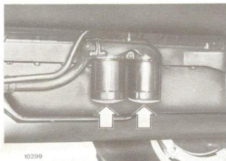
**22 FILTRES A HUILE DE RELEVAGE** - Remplacer les filtres: huiler les joints, visser les cartouches et les bloquer à la main sur 3/4 de tour. Faire le plein d'huile (opération n. 26).
