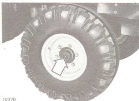
**25 MOYEURS DE ROUES AVANT** - Dévisser les couvercles des moyeux, les remplir de graisse Fiat G9 et les remonter.
