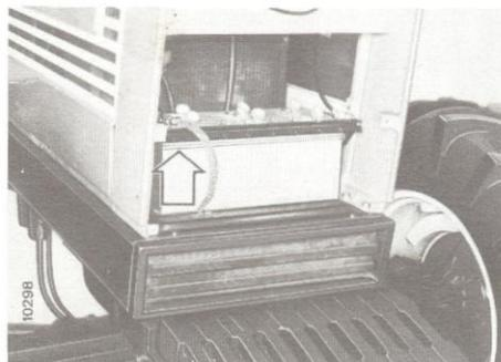
**8 BATTERIE** - Moteur arrêté, tracteur à plat et batterie reposée et froide, vérifier le niveau de l'électrolyte (voir la Notice).
