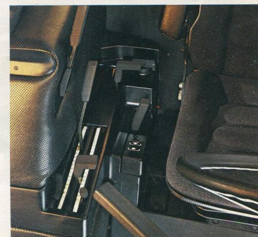
Nouveau siège avec appui-tête et accoudoirs escamotables; réglage en horizontalité lorsque le tracteur est en dévers.
