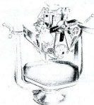
Fig. 11 - Motore montato sul quadrante rotabile per la revisione.
