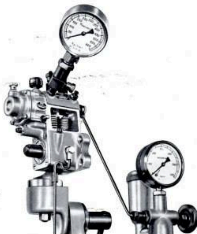
Fig. 132 - Prova di tenuta dei raccordi per tubazioni di mandata agli iniettori.
