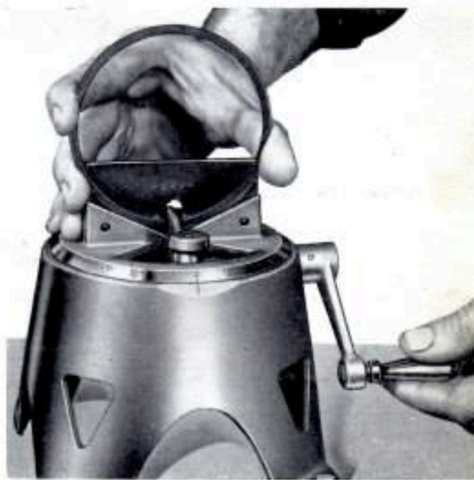
Fig. 64 - Revisioni e controlli degli organi del motore: molatura estremità anelli elastici.
