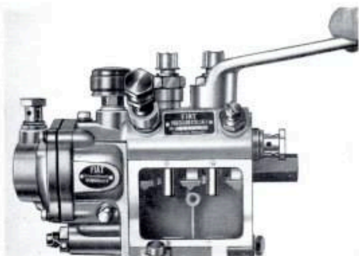
Fig. 115 - Smontaggio dei raccordi per tubazioni di mandata agli iniettori.
