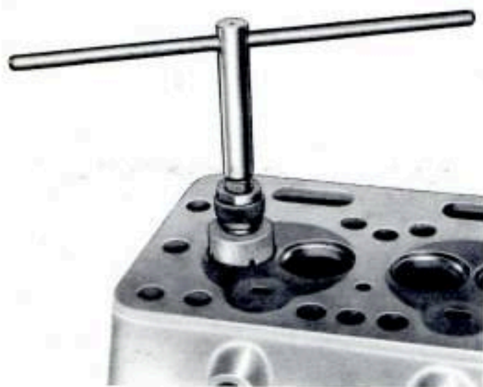
Fig. 39 - Revisioni e controlli degli organi del motore: impiego della mola per smerigliatura iniziale delle sedi valvole sulla testa cilindri.
