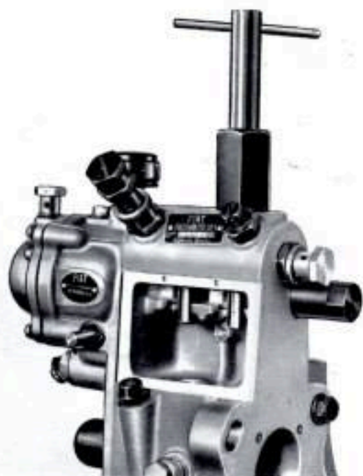
Fig. 116 - Estrazione delle valvole con portavalvola.
