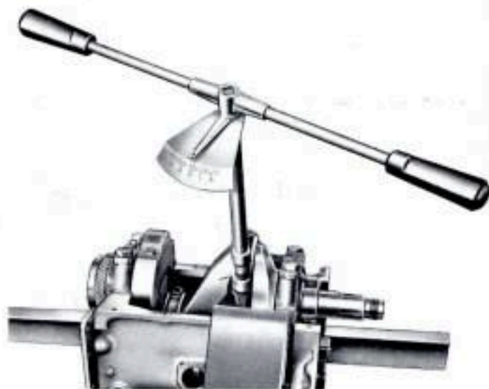
Fig. 76 - Revisioni e controlli degli organi del motore: serraggio viti cappelli biella con chiave dinamometrica.
