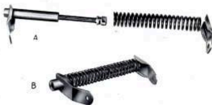
Fig. 209 - Montaggio della molla del comando bloccaggio differenziale nell'attrezzo.
