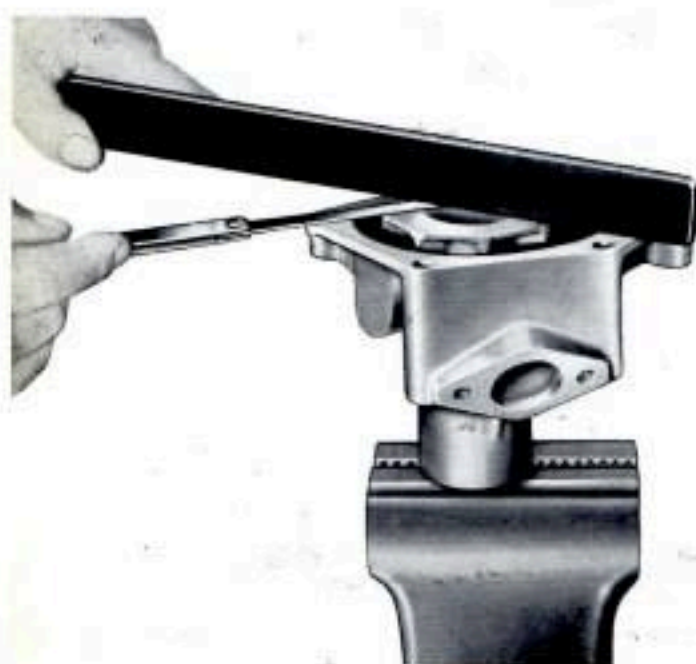
Fig. 86 - Revisioni e controlli degli organi del motore: montaggio della pompa acqua: è opportuno controllare che esista una luce tra il piano di attacco della pompa al gruppo cilindri ed il piano della girante.
