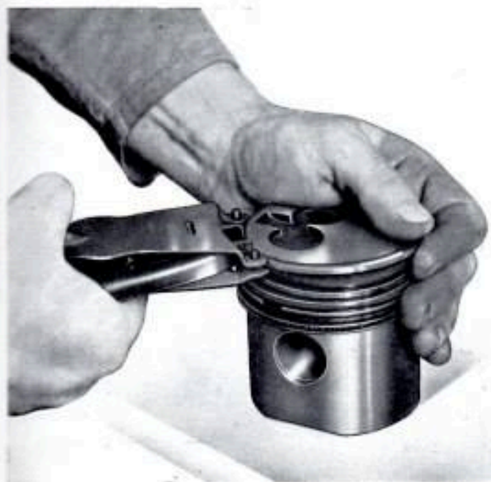
Fig. 62 - Revisioni e controlli degli organi del motore: smontaggio e montaggio anelli elastici.
