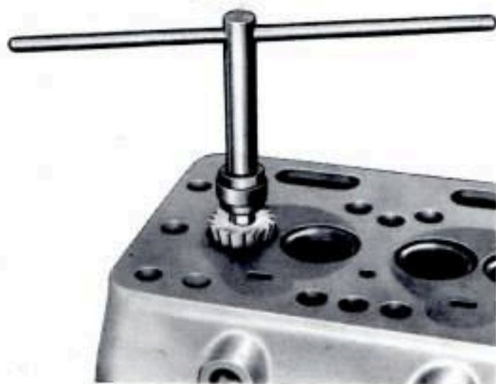
Fig. 41 - Revisioni e controlli degli organi del motore: impiego della fresa per ridurre la larghezza delle sedi valvole.
