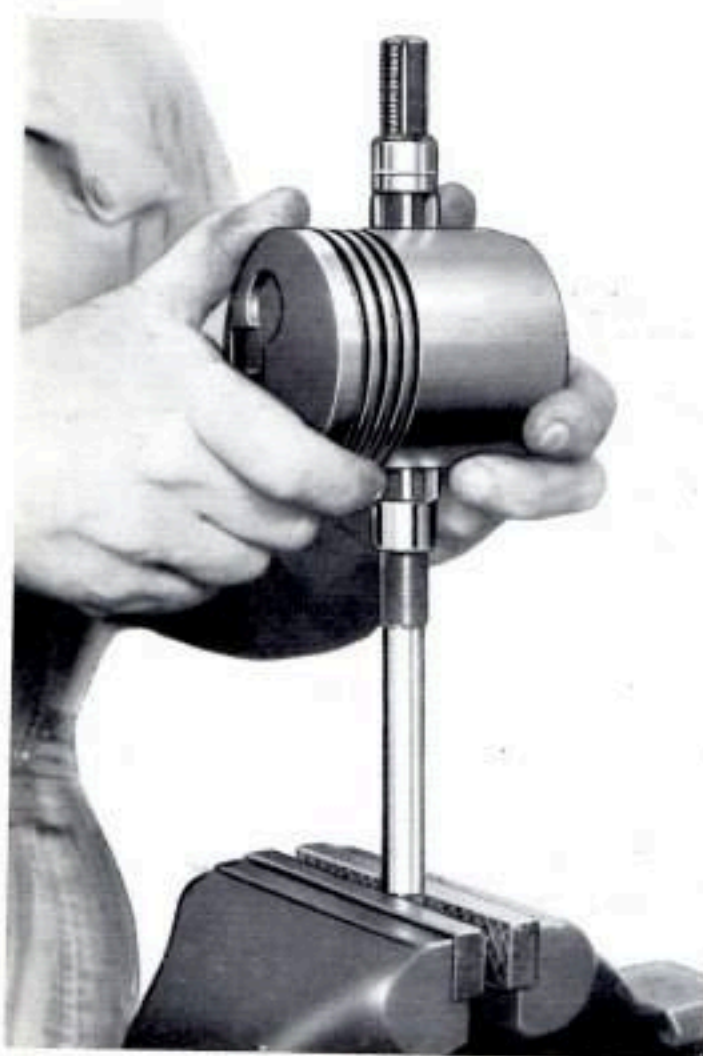
Fig. 59 - Revisioni e controlli degli organi del motore: ripassatura del foro per perno stantuffo.
