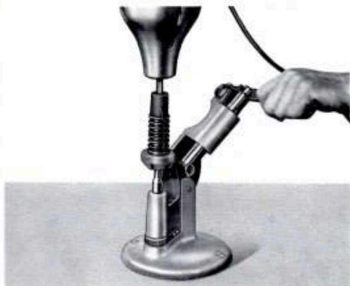
Fig. 42 - Revisionsi e controlli degli organi del motore: rettificazione della mola conica per apparecchio "Vibrocentric".
