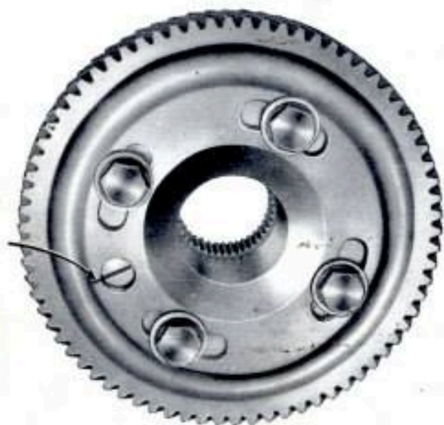
Fig. 153 - Ingranaggio di comando pompa iniezione (la freccia indica la corrispondenza dei segni sul manicotto e sull'ingranaggio, da osservare al montaggio).
