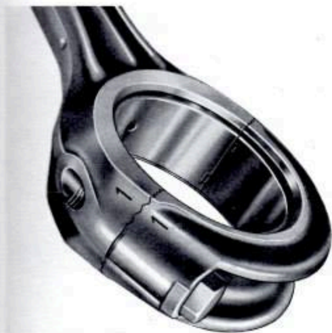
Fig. 69 - Revisioni e controlli degli organi del motore: numeri di riferimento sulle bielle.
