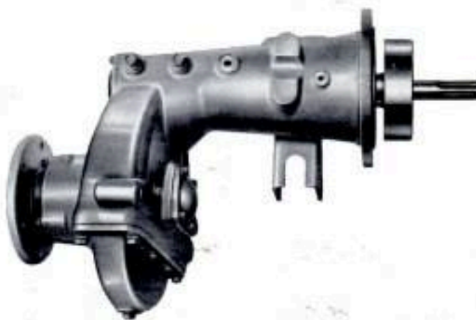
Fig. 180 - Gruppo riduttore laterale completo.
