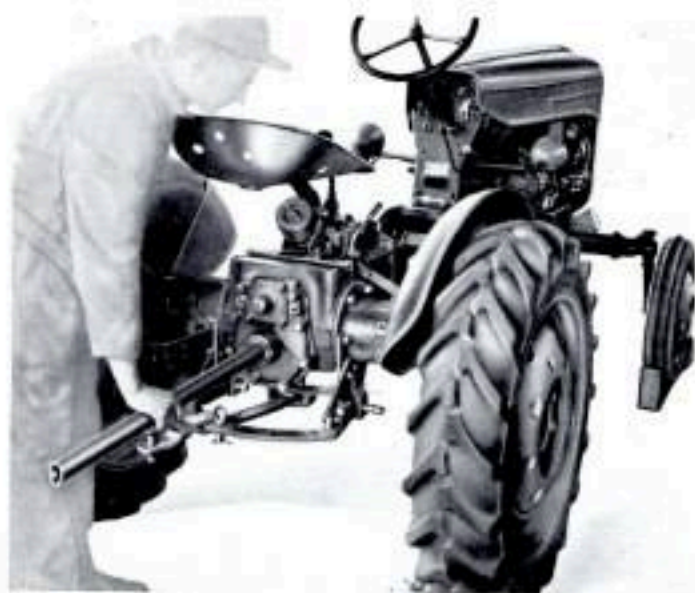
Fig. 177 - Distacco della parte anteriore della trattrice dal gruppo cambio e riduttori.
