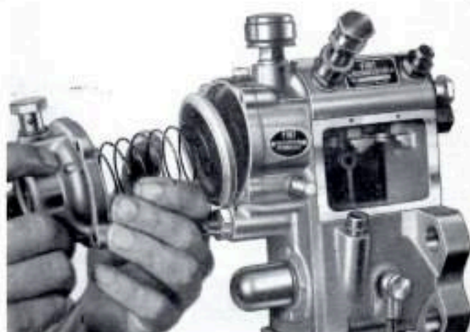
Fig. 118 - Particolare dello smontaggio del regolatore di velocità.
