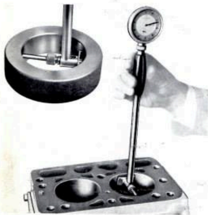
Fig. 54 - Revisioni e controlli degli organi del motore: controllo del diametro interno delle canne cilindri per la determinazione dell'usura. (In alto è illustrato il calibro ad anello)
