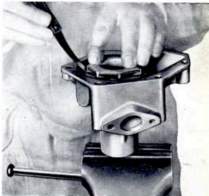
Fig. 84 - Revisioni e controlli degli organi del motore: montaggio della pompa acqua: è opportuno controllare che esista una luce tra le palette della girante e la parete del corpo pompa.
