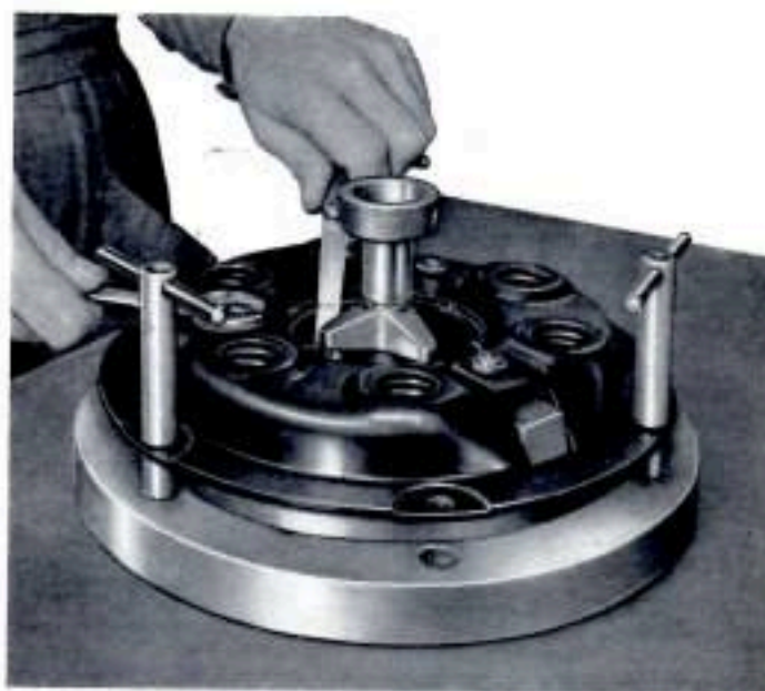
Fig. 169 - Montaggio e registrazione della frizione.
