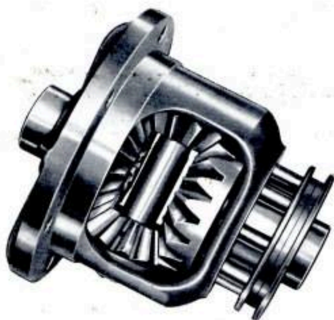
Fig. 211 - Differenziale e manicotto di bloccaggio.
