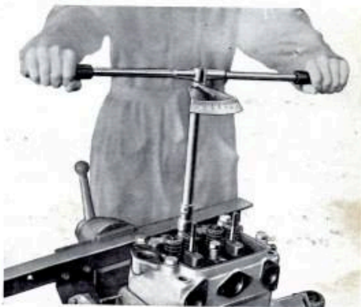
Fig. 151 - Rimontaggio del motore: impiego della chiave dinamometrica per le viti fissaggio testa cilindri.
