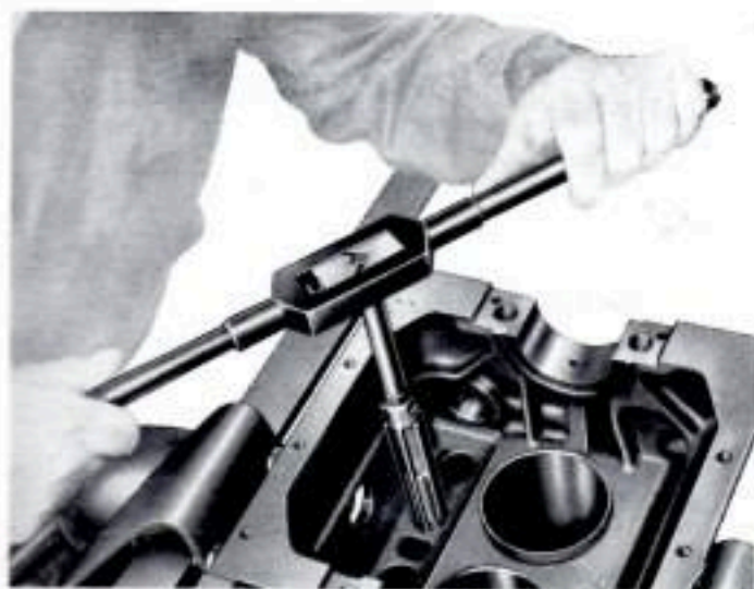
Fig. 49 - Revisioni e controlli degli organi del motore: ripassatura delle sedi per punterie.
