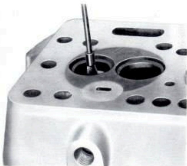
Fig. 35 - Revisionsi e controlli degli organi del motore: pulizia del foro guida-valvole.
