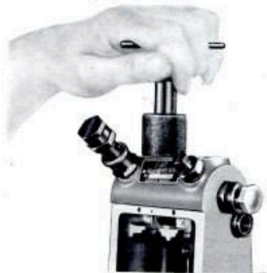
Fig. 124 - Ripassatura delle sedi di alloggiamento dei cilindri nel corpo pompa.
