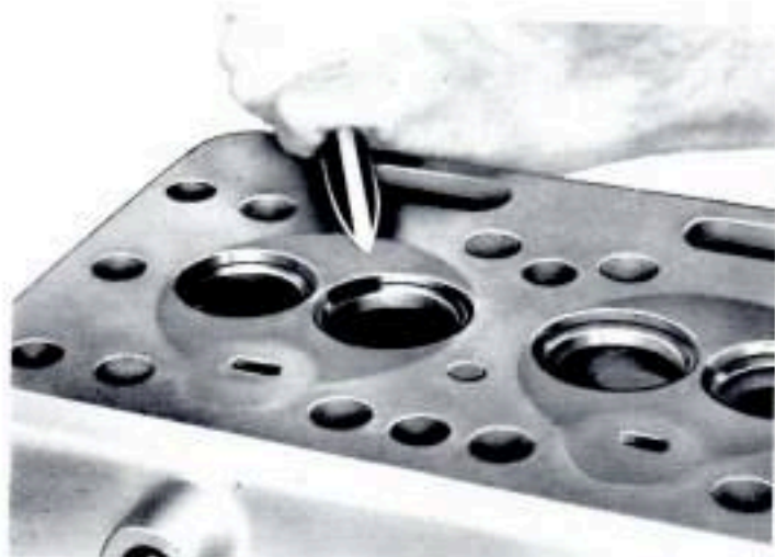
Fig. 28 - Revisionsi e controlli degli organi del motore: pulizia del piano superiore della testa cilindri.
