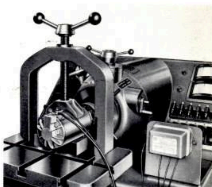
Fig. 259 - Dinamo col proprio gruppo di regolazione sul banco prova.
