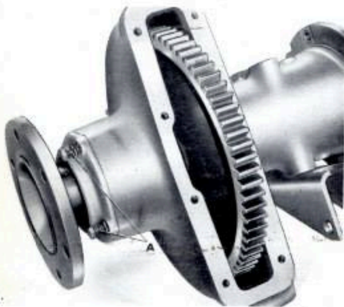
Fig. 182 - Smontaggio di un gruppo riduttore nelle sue parti: vengono tolte le viti fissaggio coperchio esterno (A) per sfilare l'albero ingranaggio condotto.
