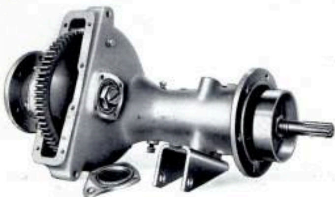
Fig. 181 - Smontaggio di un gruppo riduttore nelle sue parti: è stato tolto il coperchio interno albero ingranaggio condotto.
