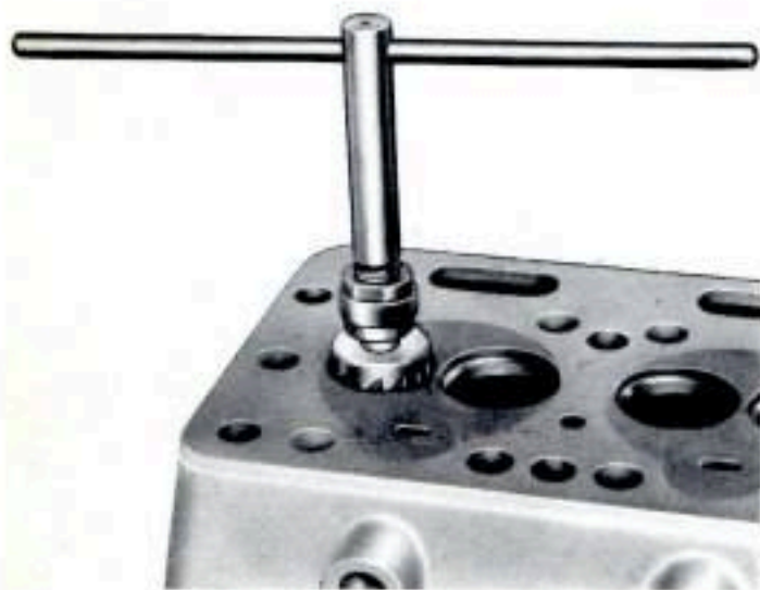
Fig. 40 - Revisioni e controlli degli organi del motore: ripassatura delle sedi valvole sulla testa cilindri.
