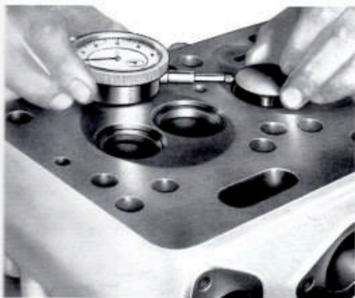
Fig. 36 - Revisionsi e controlli degli organi del motore: controllo del giuoco fra lo stelo delle valvole ed il foro della guida.
