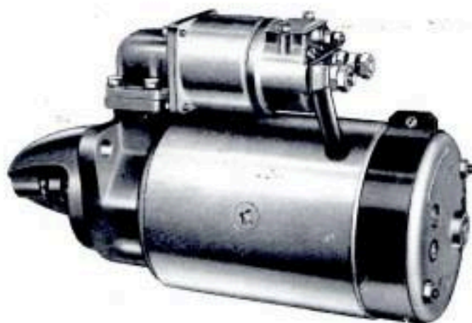
Fig. 275 - Motore di avviamento FIAT E115-1,8/12-S-Var. 3 .
