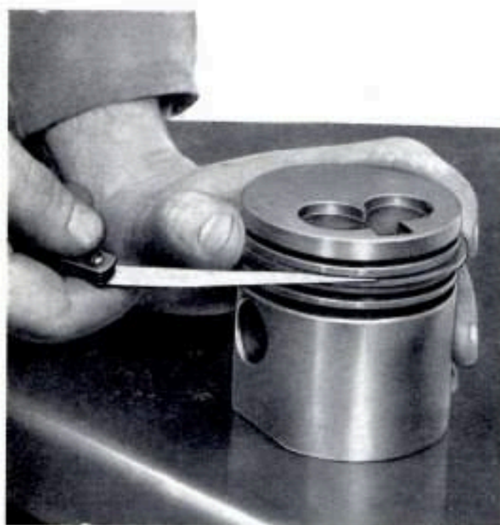
Fig. 65 - Revisionsi e controlli degli organi del motore: controllo del giuoco tra anelli elastici e fianchi delle cave sullo stantuffo.
