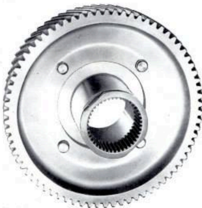
Fig. 27 - Ingranaggio comando pompa iniezione (Notare la scanalatura per anello elastico).
