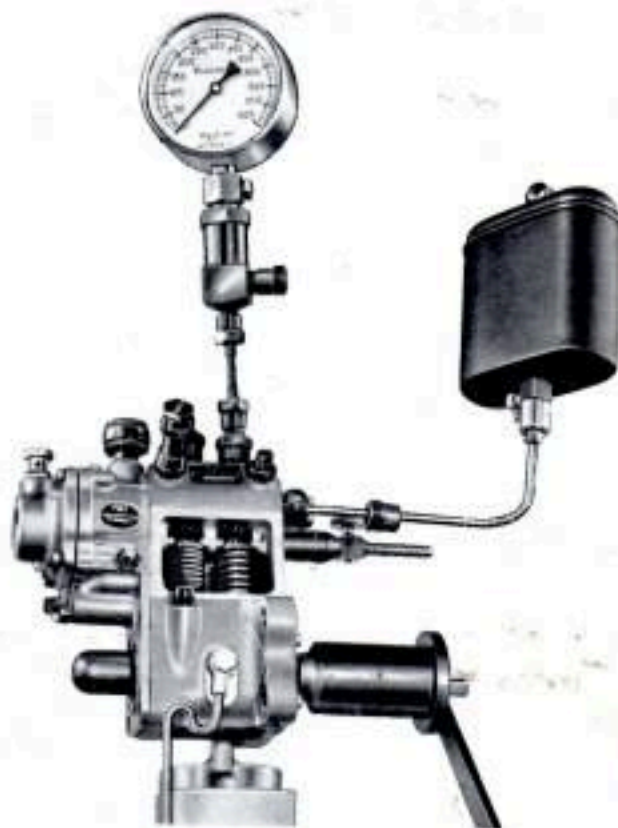
Fig. 133 - Prova di tenuta dei pompanti a pompa iniezione montata.
