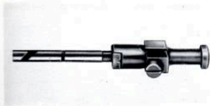
Fig. 125 - Prolunga per montaggio del pompante nell'attrezzo di cui alla fig. 126.
