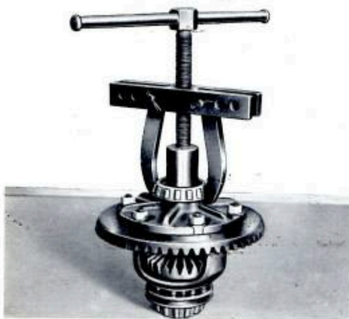
Fig. 212 - Estrazione dei cuscinetti a rulli conici per differenziale (attrezzo A 537005).
