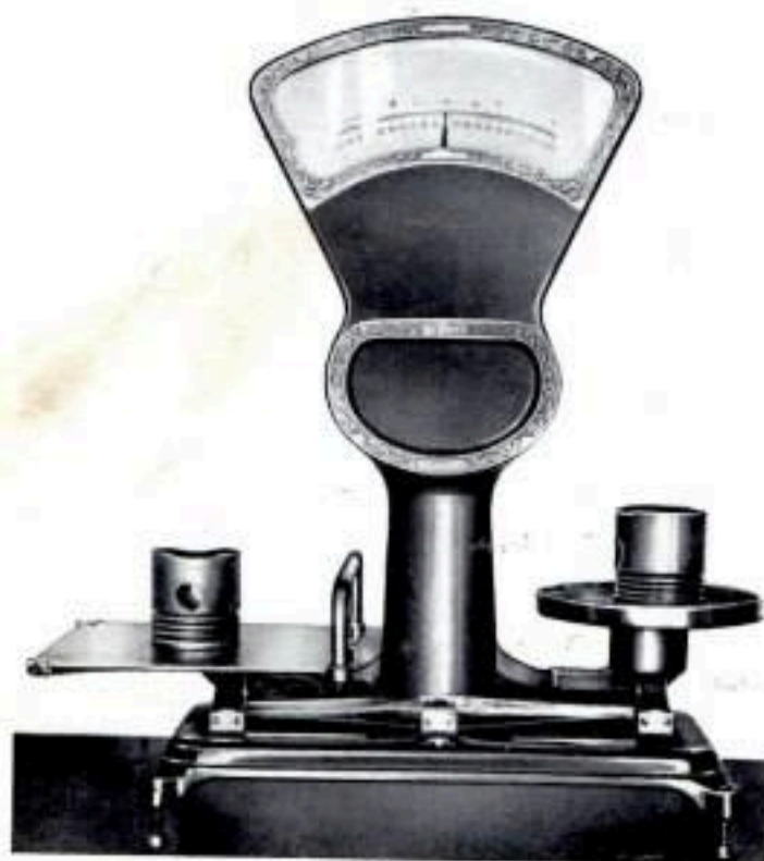
Fig. 60 - Revisioni e controlli degli organi del motore: controllo del peso degli stantuffi.
