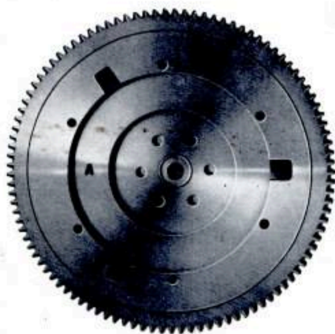
Fig. 171 - Volano motore (vista frontale). A - Superficie di lavoro del disco condotto frizione
