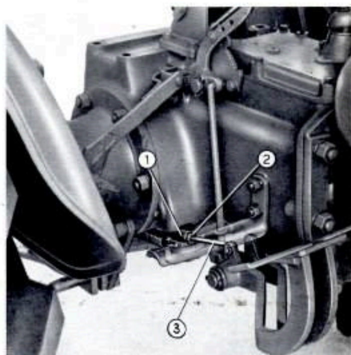
Fig. 218 - Registrazione corsa a vuoto dei pedali freno. 1. Forcellino per tirante. - 2. Dado di registro. - 3. Tirante di regolazione.
