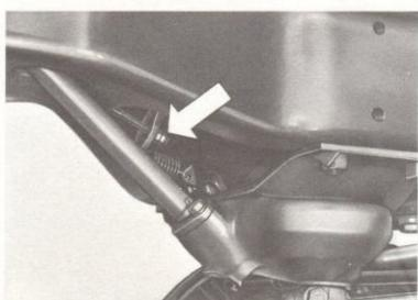
**6 EMBRAYAGE** - Si la garde de la pédale est inférieure à 30 mm, la rétablir en desserrant ce qu'il faut les écrous indiqués.
