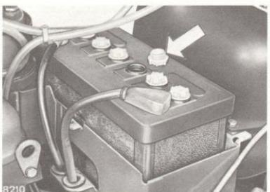
**3 BATTERIE** - Moteur arrêté, tracteur à plat et la batterie reposée et froide, vérifier le niveau de l'électrolyte dans chaque élément.
