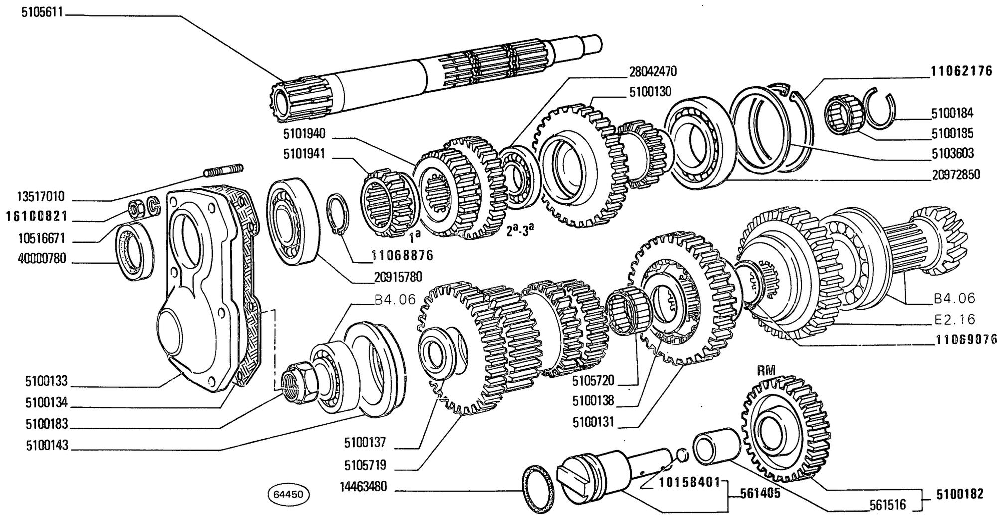
**RUOTISMI CAMBIO DI VELOCITÀ**
