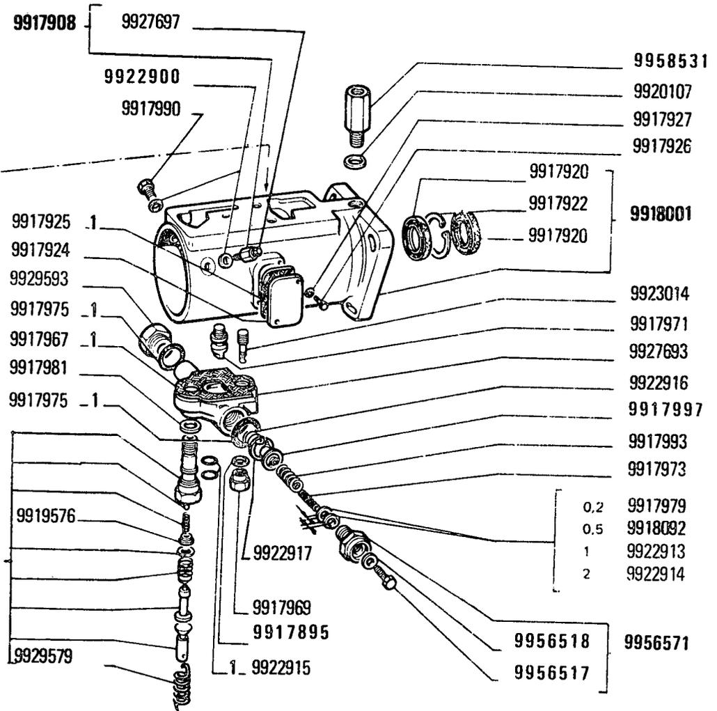
POMPA INIEZIONE 771035 (C.A.V.)
