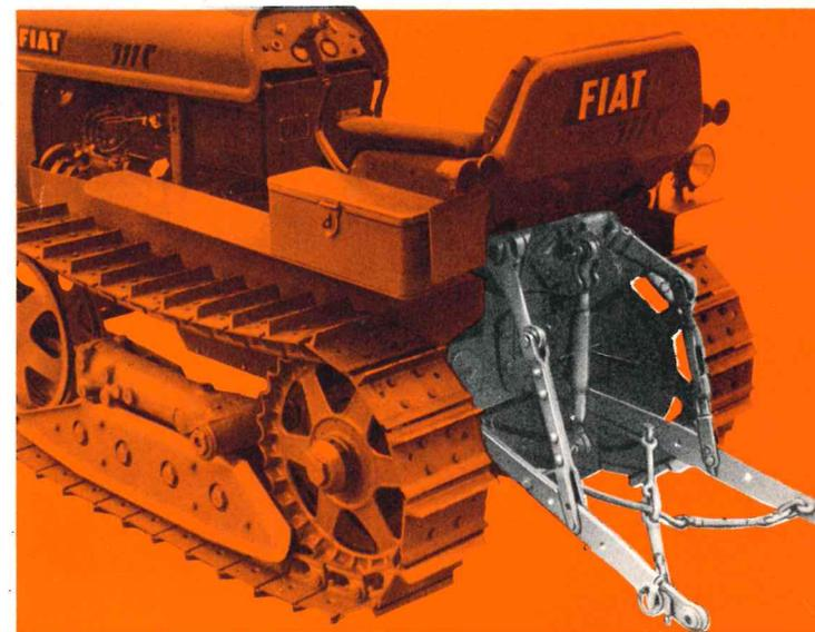
Sollevatore idraulico con autocontrollo della profondità di lavoro degli attrezzi
