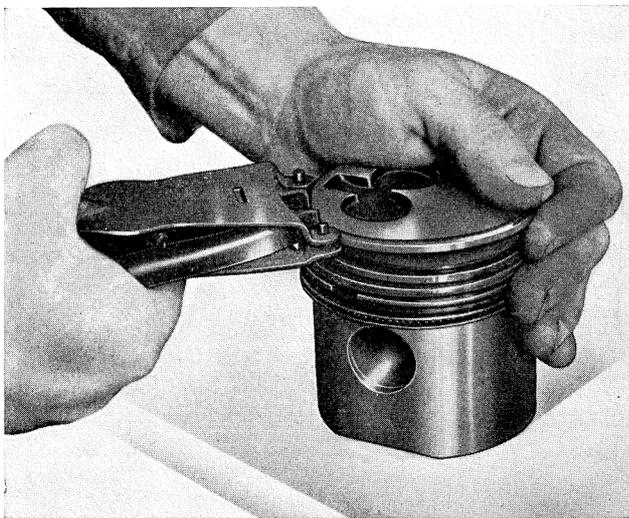
Fig. 29 - Pince A 619022 pour le démontage et le montage des segments.
