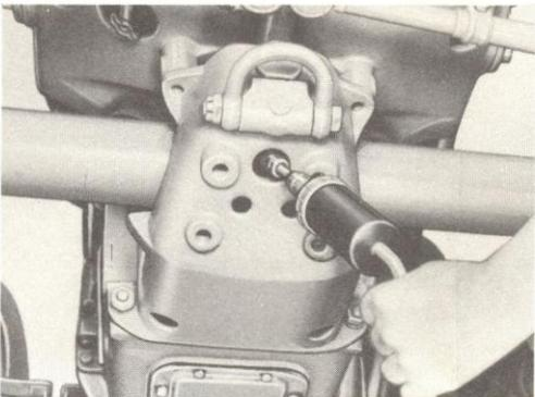
**6 AXE D'ARTICULATION DE L'ESSIEU** Injecter de la graisse Fiat G 9 (un graisseur).
