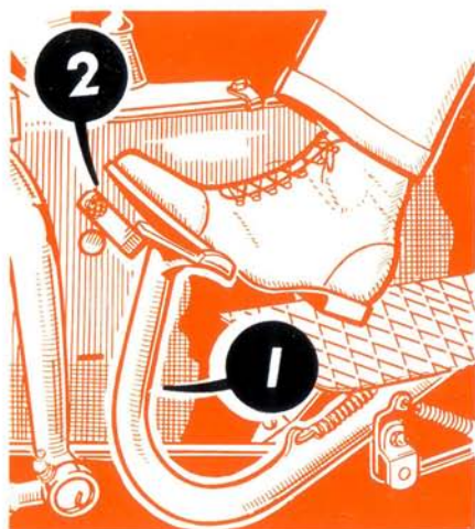
FIG. 6 A. — Pédale de débrayage (1) avec course limitée par la butée (2)
