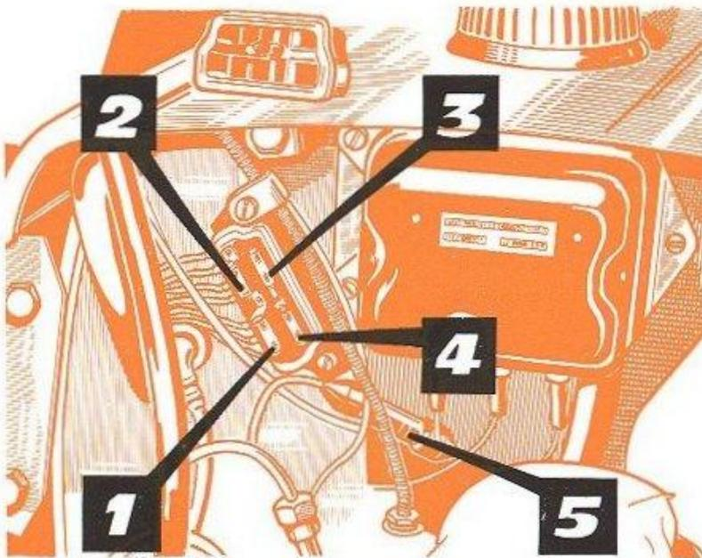
**FIG. 29** — Fusibles de protection des appareils d'éclairage.
