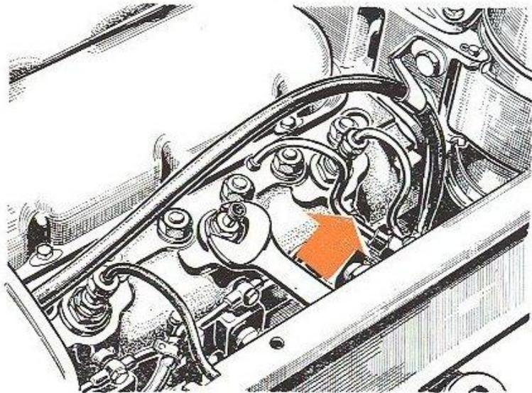
Pour déposer les injecteurs, ôter les tuyauteries et leur écrou de fixation (fig. 27). Pour les remonter, se servir d'une clé dynamométrique (couple le serrage **6 m.kg.**)
