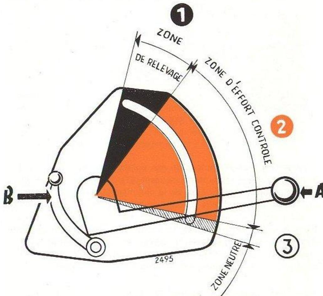
**FIG. 16** — Action du levier de commande du relevage.
