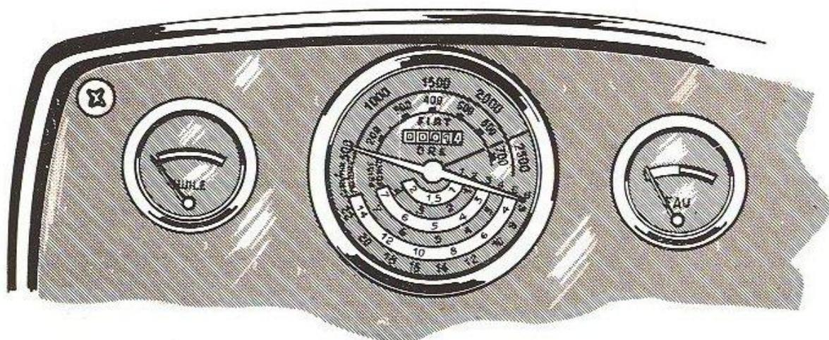
**FIG. 22** — Horomètre au centre de l'horotachymètre.
