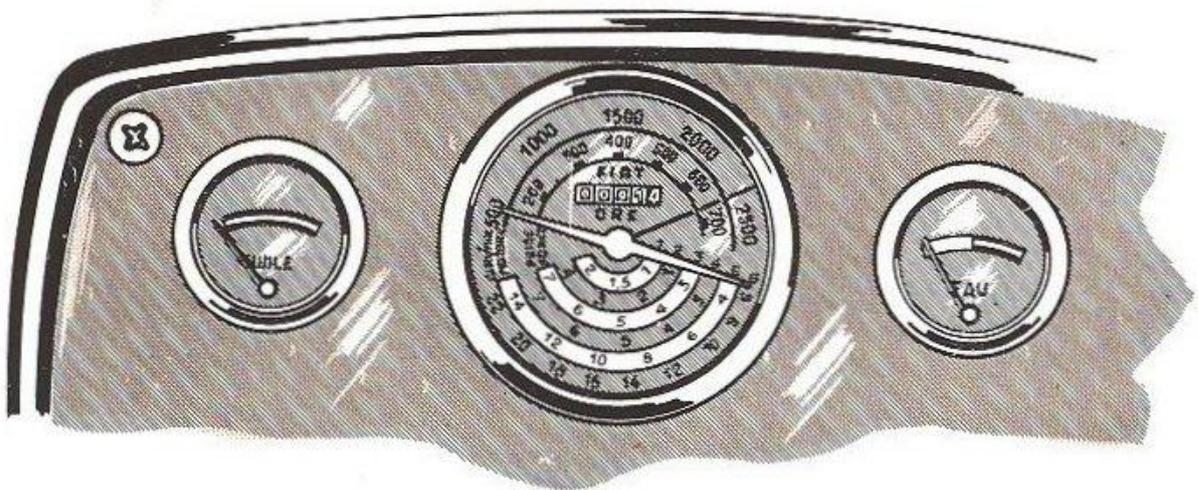
FIG. 13 — Horotachymètre.
