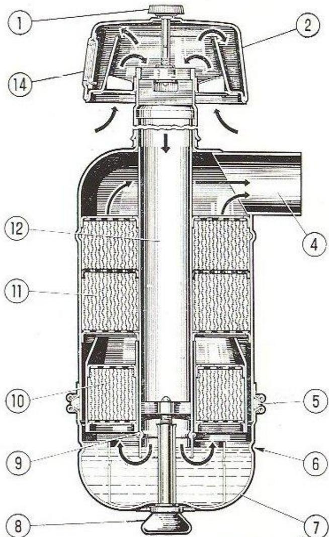
inférieure et vérifier si l'huile arrive à la rainure circulaire. Le niveau d'huile devra être vérifié une demi-heure au moins après l'arrêt du moteur de sorte que l'huile en suspension dans les masses filtrantes, ait le temps de descendre dans la cuve.
