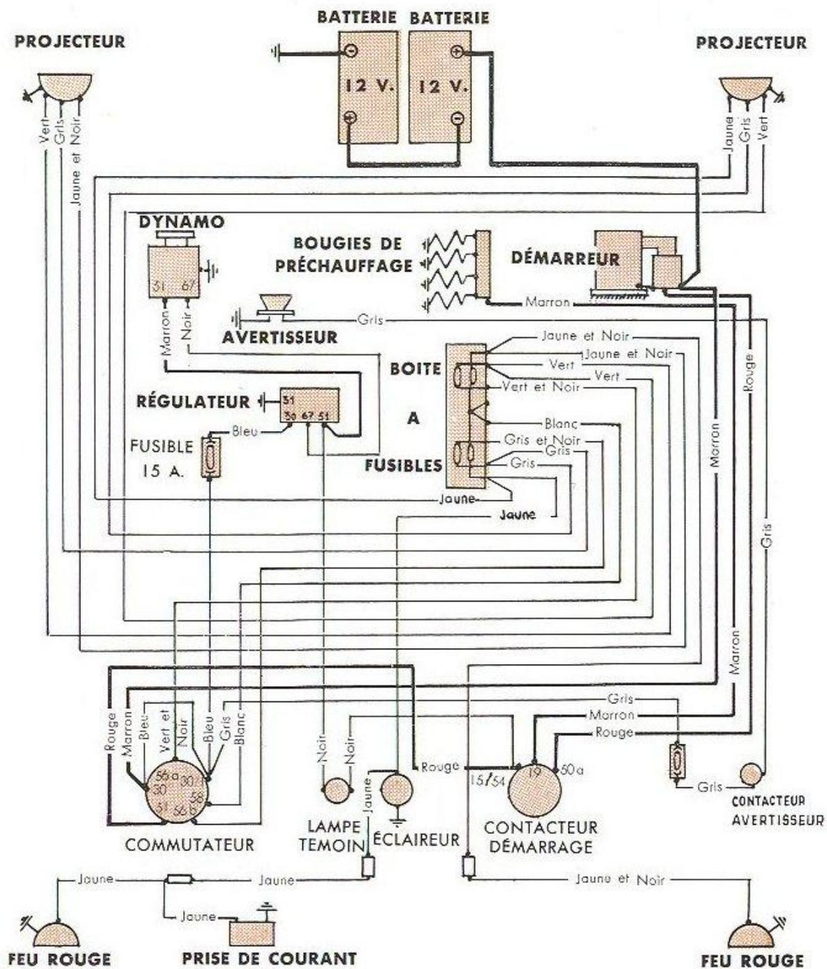
FIG. 30 = Schéma de câblage électrique.
