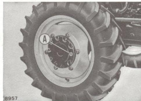
**25 REDUCTEURS DES ROUES AVANT (DT) -** Vérifier que l'huile affleure au bouchon A après avoir positionné ce bouchon à l'horizontale. Faire l'appoint par ce même bouchon.
