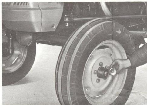
**20 ROUES AVANT -** Remplir les chapeaux des moyeux de graisse FIAT G9 et les remonter. En terrains marécageux, les lubrifier plus souvent.
