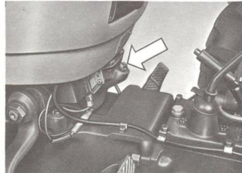
**23 BOITIER DE DIRECTION -** Vérifier que l'huile affleure au bouchon; si nécessaire faire l'appoint par ce même bouchon (utiliser FIAT AMBRA 20W/40).
