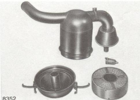
**19 FILTRE A AIR -** Nettoyer toutes les pièces. Plonger les masses une 1/2 heure dans du pétrole. Les égoutter et les humidifier d'huile avant remontage.
