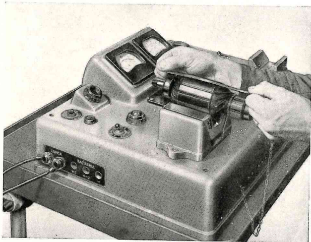
Fig. 217 - Verifica dell'indotto con una lamella.
