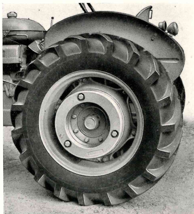
Fig. 202 - Ruota motrice completa di zavorre.
