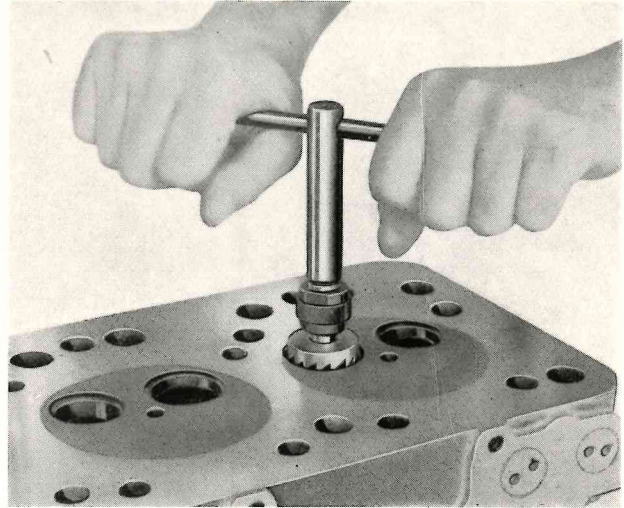
Fig. 25 - Ripassatura delle sedi valvole mediante mola.
