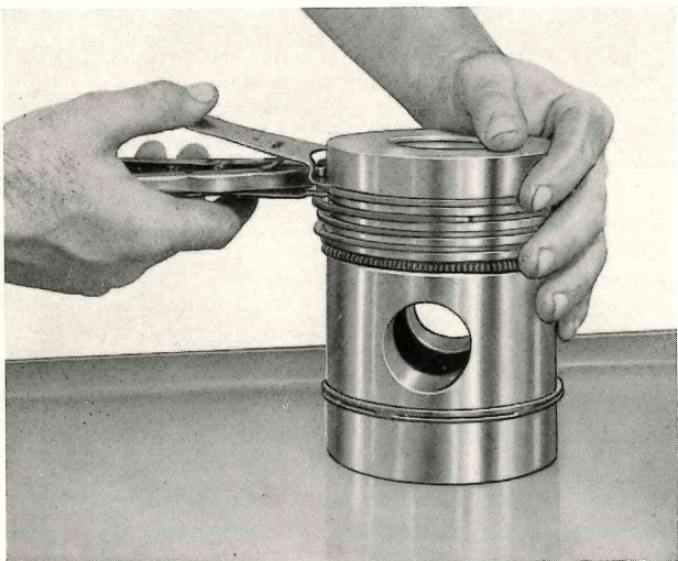
Fig. 39 - Smontaggio degli anelli elastici, mediante le pinze.
