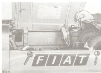
17 RESERVOIR DE DIRECTION ASSISTEE - Dévisser le bouchon: si l'huile n'arrive pas au cran de la jauge, faire l'appoint.
