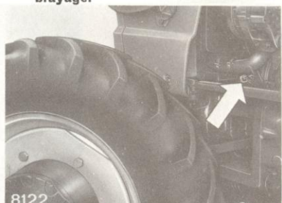
12 COMMANDE DE DIRECTION (DT) - Injecter de la graisse FIAT G 9 avec la pompe.
