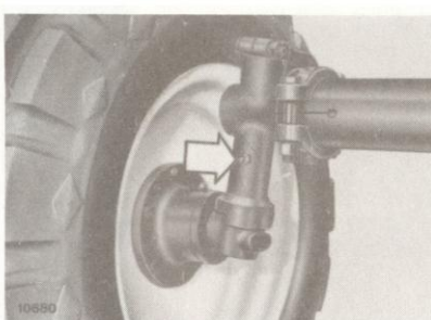
14 FUSEES DE ROUES - Injecter de la graisse FIAT G 9 avec la pompe (2 graisseurs, un par côté).
