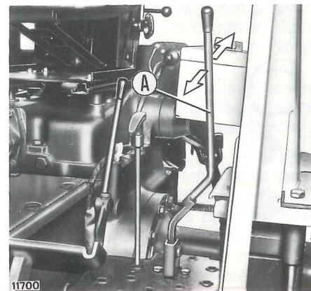
Pour enclencher le réducteur supplémentaire, arrêter le tracteur, débrayer l'avancement et tirer en arrière le levier **A** illustré à la figure.
