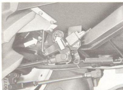
**16 PEDALES DE FREINS ET BLOCAGE DU DIFFERENTIEL** - A l'aide d'une pompe, injecter de la graisse FIAT G 9 (deux graisseurs).
