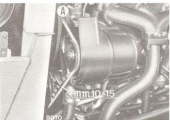
**4 COURROIE DE VENTILATEUR** - Vérifier la flèche (10 - 15 mm) sous une charge de 49÷69 N - 5÷7 kg). Pour le réglage, agir sur l'écrou A.
