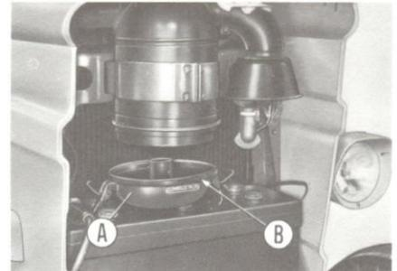
**7 FILTRE A AIR** - Moteur arrêté depuis un quart d'heure au moins, contrôler que le niveau de l'huile dans la cuve A arrive au bourrelet B; faire l'appoint, si nécessaire, avec de l'huile moteur.
