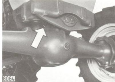
**16 AXE DE PIVOTEMENT DE PONT AV (DT)** - Injecter de la graisse FIAT G9 avec la pompe.
