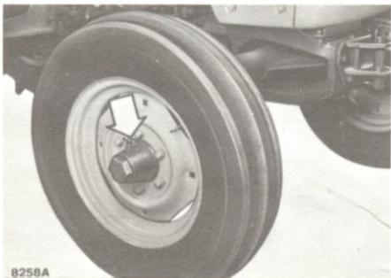
**25 ROUES AVANT** - Injecter de la graisse FIAT G 9 à l'aide d'une pompe dans les deux graisseurs (1 par roue). En terrains marécageux graisser plus souvent.
