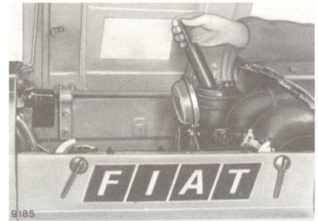
**29 RESERVOIR DE DIRECTION ASSISTEE** - Démontez le filtre et le laver au pétrole. Laver également le bouchon d'accès au filtre.
