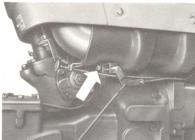
**35 RESERVOIR A COMBUSTIBLE** - Le réservoir étant presque vide, évacuer les impuretés (eau et dépôts) en dévissant le bouchon inférieur.
