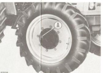
**32 REDUCTEURS DE PONT AVANT (DT)** - Amener le bouchon A en position horizontale et vérifier le niveau de l'huile; faire l'appoint par ce bouchon.
