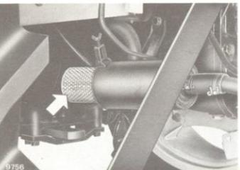
**24 FILTRE DE RELEVAGE** - Remplacer la cartouche. Nettoyer l'intérieur du boîtier. Rétablir le niveau sans réutiliser l'huile vidangée (voir op. n. 27).
