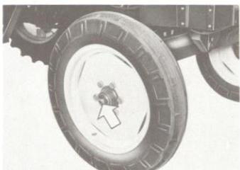
**26 ROUES AVANT** - Dévisser les chapeaux des moyeux, les remplir de graisse FIAT G9 et les remonter.
