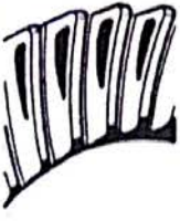
Fig. 7/19. - Portées des dents du pignon d'attaque sur les dents de la couronne.
