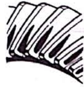
Fig. 7/19. - Portées des dents du pignon d'attaque sur les dents de la couronne.
