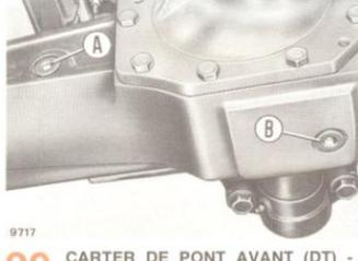
**29 CARTER DE PONT AVANT (DT)** - Vérifier que l'huile arrive au bouchon A. Si néces. en ajouter par le même bouchon (voir « Approvisionnements »).
