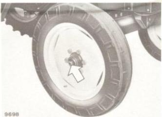
**25 ROUES AVANT** - Dévisser les couvercles des moyeux, les remplir de graisse FIAT G9 et les remonter.
