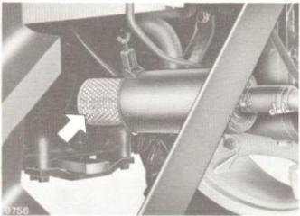
**23 FILTRE DE RELEVAGE** - Remplacer la cartouche. Nettoyer l'intérieur du container. Rétablir le niveau sans réutiliser l'huile vidangée (voir opér. n. 26).
