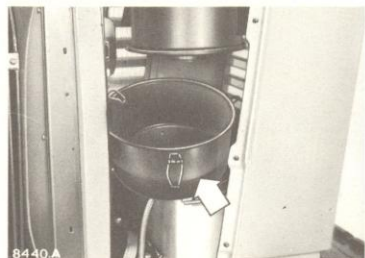
3 FILTRE A AIR A BAIN D'HUILE - Moteur arrêté depuis au moins 15 mn, s'assurer que le niveau d'huile arrive au bord indiqué.
