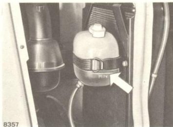
5 RESERVOIR SUPPLEMENTAIRE RADIATEUR - Le niveau d'eau doit arriver 6-7 cm au dessus du niveau "MIN".
