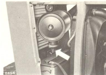
2 FILTRE A AIR - Vérifier l'état d'engorgement de la soupape de décharge en pressant l'embout en caoutchouc.
