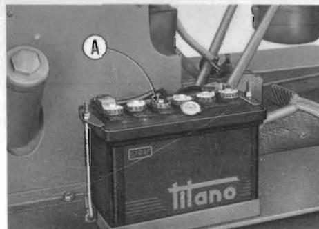
**21 BATTERIA** - Verificare il livello del liquido in ciascun elemento (ved. pag. 23 del libretto). - A = imbuto per introduzione acqua distillata.
