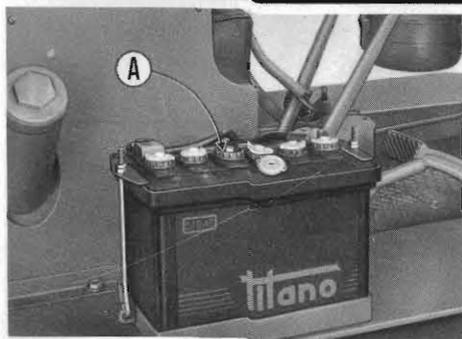
**21 BATTERIA** - Verificare il livello del liquido in ciascun elemento (ved. pag. 23 del libretto). - A = imbuto per introduzione acqua distillata.
