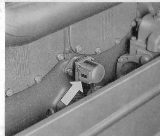
Fig. 17 - Contatore di funzionamento motore.
