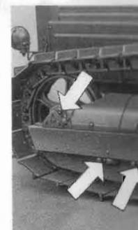
**24** **RUOTE TENDICINGOLI** - Mediante la pompa iniettare oliofiat a pressione.
