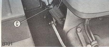
**28 FILTRE A HUILE D'EMBRAYAGE CENTRAL** - Déposer la plaque au côté gauche du carter, desserrer la vis A (elle ne peut être enlevée), déposer le filtre B et le laver au pétrole. Le passer à un jet d'air, vérifier qu'il n'est pas cassé et que le joint C est en bon état. Remonter le filtre et s'assurer finalement que la pompe à huile est amorcée (voir « Notes sur l'Entretien »).
