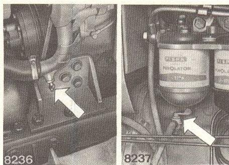
**36 SYSTÈME DE REFROIDISSEMENT DU MOTEUR** - Vidanger l'eau par les robinets et rincer le système de refroidissement.
