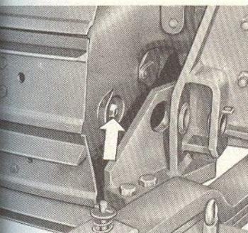
**DUCTEURS LATÉRAUX** - Vérifier que l'huile arrive au bouchon; l'opération sera faite par ce même bouchon (voir «Notes sur l'Entretien AW 90/M»).
