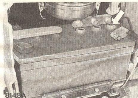
**3 BATTERIE** - Vérifier le niveau dans chaque élément, moteur arrêté, tracteur en palier et la batterie reposée et froide.
