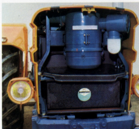
Le filtre à air et la batterie se trouvent à l'avant du tracteur, totalement isolés du moteur.
