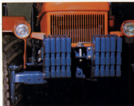
Masses d'alourdissement placées sur berceau à l'avant du tracteur (sur demande, possibilité de montage d'un berceau double).
