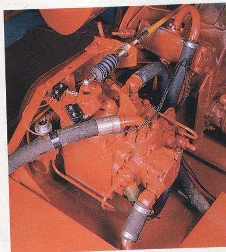
La Laverda Intégrale est équipée, de série, d'une transmission hydrostatique. Progressive dans les manœuvres et puissante en montée, elle assure un bon freinage dans les descentes.
