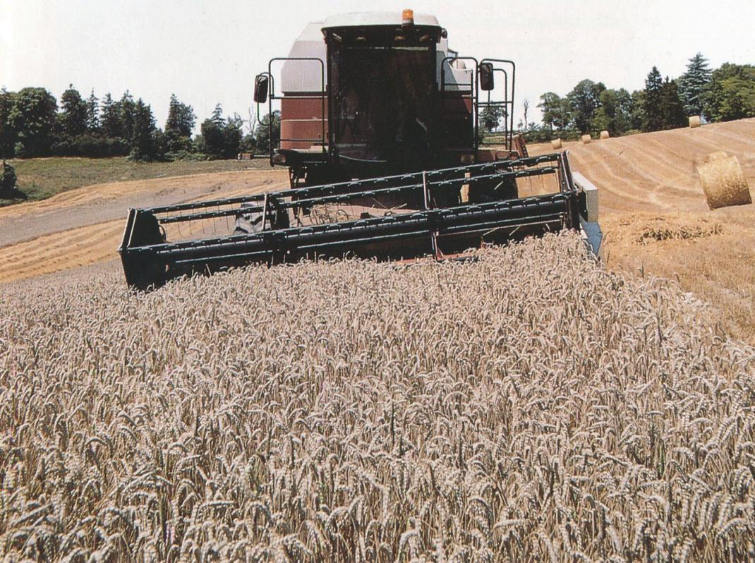
Lors du battage de produits versés, petits pois ou petites graines, la table de coupe peut influencer le comportement de la machine. Contacts avec le sol ou effets de "Bulldozer" sont éliminés car la Laverda à compensation intégrale est équipée d'un dispositif "Terra-Control".
