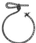
Nœud coulant sur le bout de ficelle court (Le bout arraché se trouve sous la plaquette pince-ficelle)
