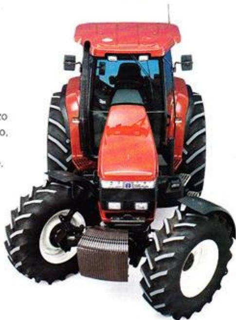
idraulico per il ponte posteriore. Gli assali sono estremamente robusti. Un esempio: il Super steer è in grado di sostenere un carico costante di 5715 kg, continuamente.
