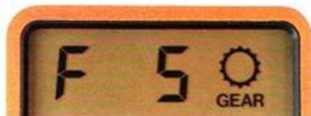
incrementare, o a sinistra per scalare. Per mettere in movimento il trattore è sufficiente spostare in avanti la leva, tenendo premuto il pulsante di consenso posto sull'impugnatura della leva stessa. Non è mai necessario utilizzare il pedale della frizione.
