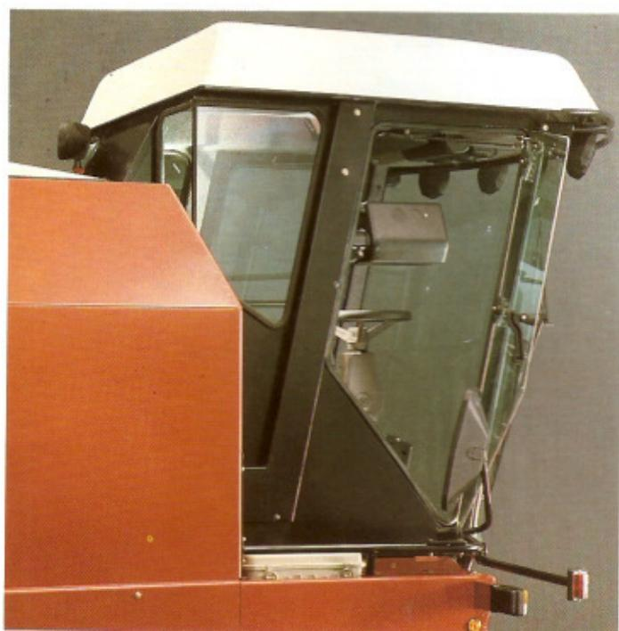
La cabina è di tipo panoramico: ottima visibilità quindi, sia sulla piattaforma di taglio, sia lateralmente per le manovre. È montata su silent-bloc, pertanto risulta perfettamente isolata da vibrazioni e dai rumori indotti. I vetri sono atermici e antiriflesso; monoterpicristallo gigante; aria condizionata a regolazione fine; piantone e sedile di guida registrabili su misura; disposizione ergonomica di tutti i comandi e controlli.
