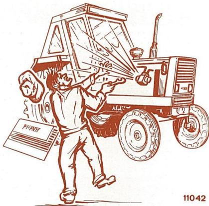
■ Le mélange d'huile et de réfrigérant à l'intérieur du système est sous pression. Il faut donc absolument éviter de toucher aux raccords et canalisations.
