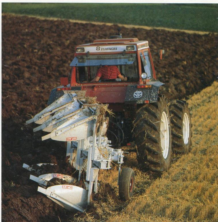
Les labours se font entre 4 et 9 km/h, suivant les terrains et les outils, c'est-à-dire en utilisant les gammes lentes ou moyennes.
