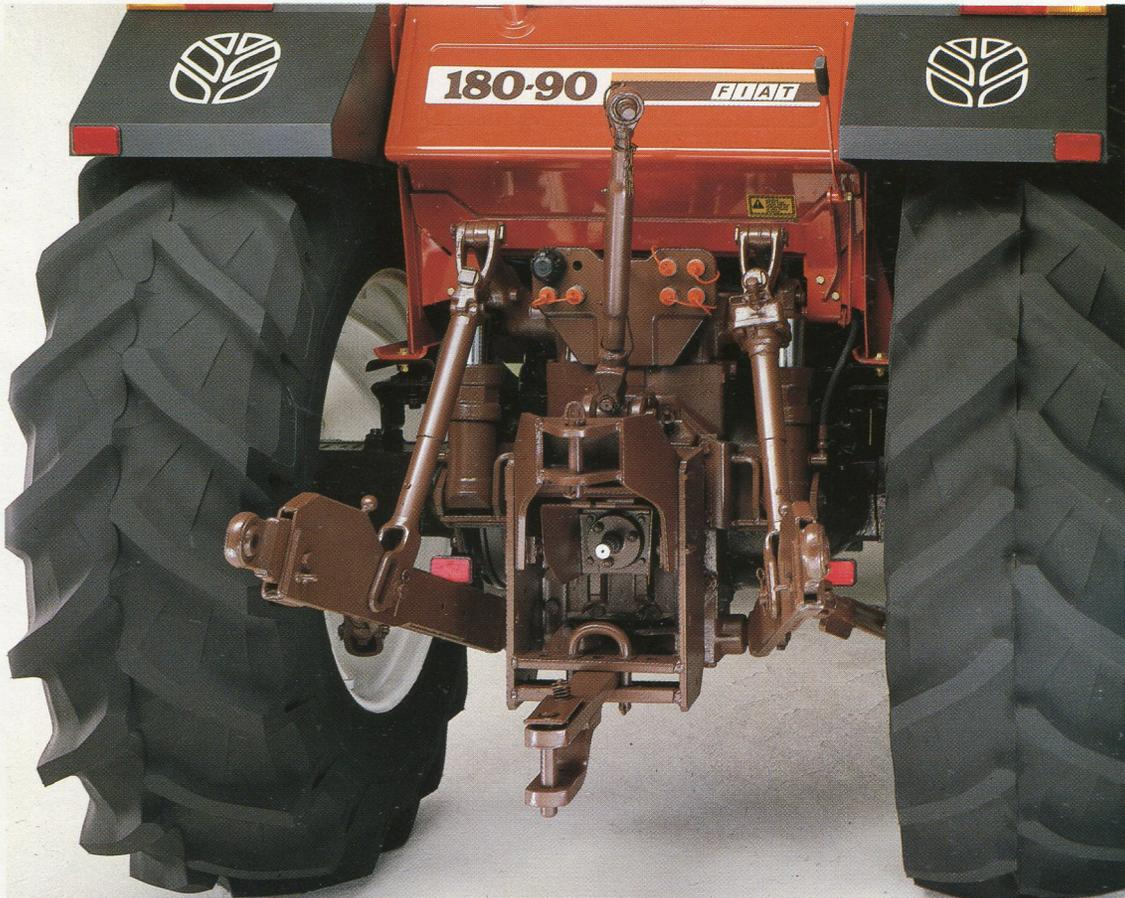
Entraîné par une grosse pompe à engrenages, d'un débit de 55,8 litres/mn et à une pression de tarage de 175 kg/cm<sup>2</sup> avec double filtre à cartouche sur l'aspiration.
