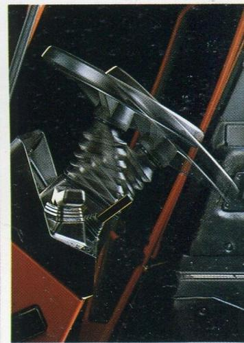
Le volant est réglable en inclinaison et en hauteur pour s'adapter à toute taille ou position de conduite.
