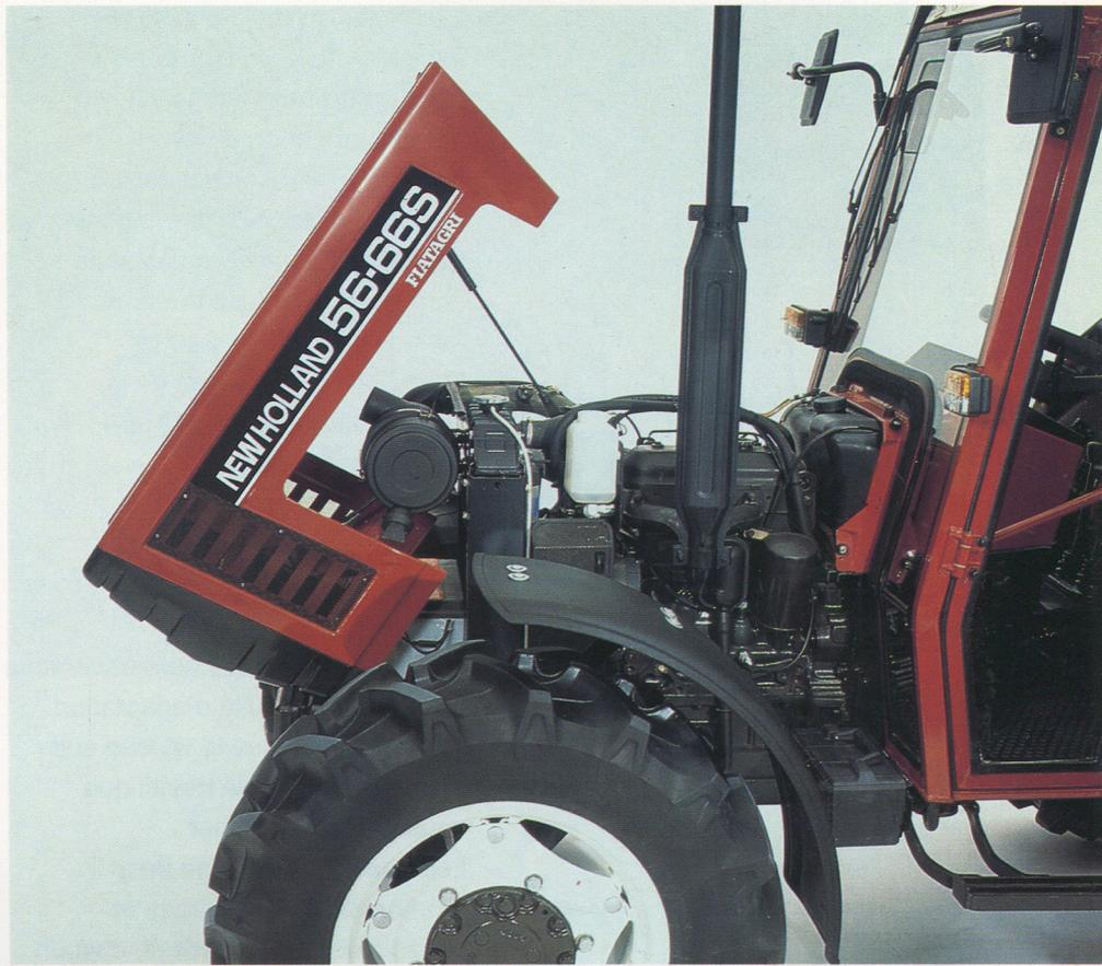
Le capot moteur en une seule pièce bascule vers l'avant pour faciliter l'accès aux différentes pièces du moteur.
