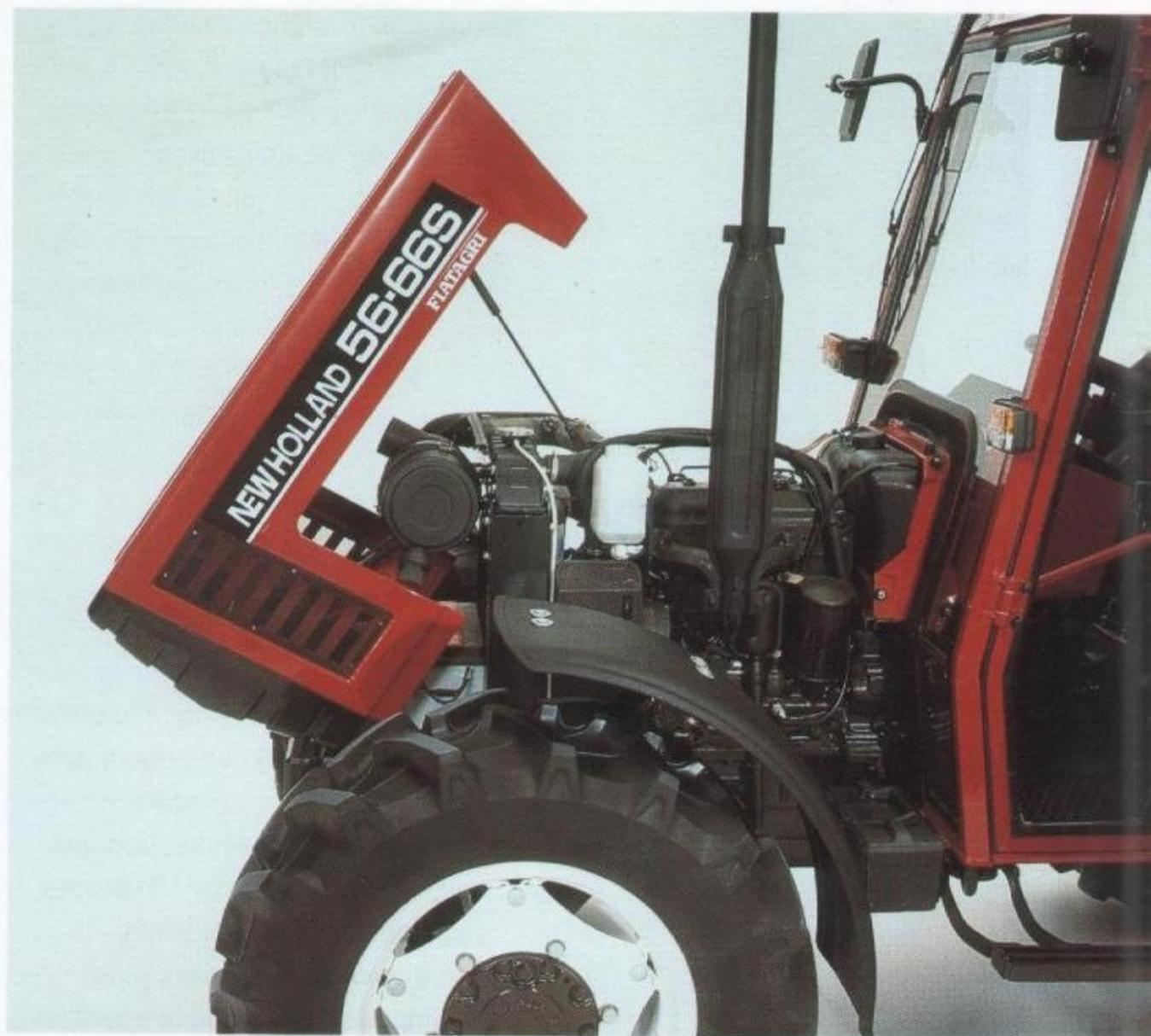
*Il cofano monoblocco del motore si ribalta semplicemente in avanti per permettere un facile accesso ai componenti del motore.*
