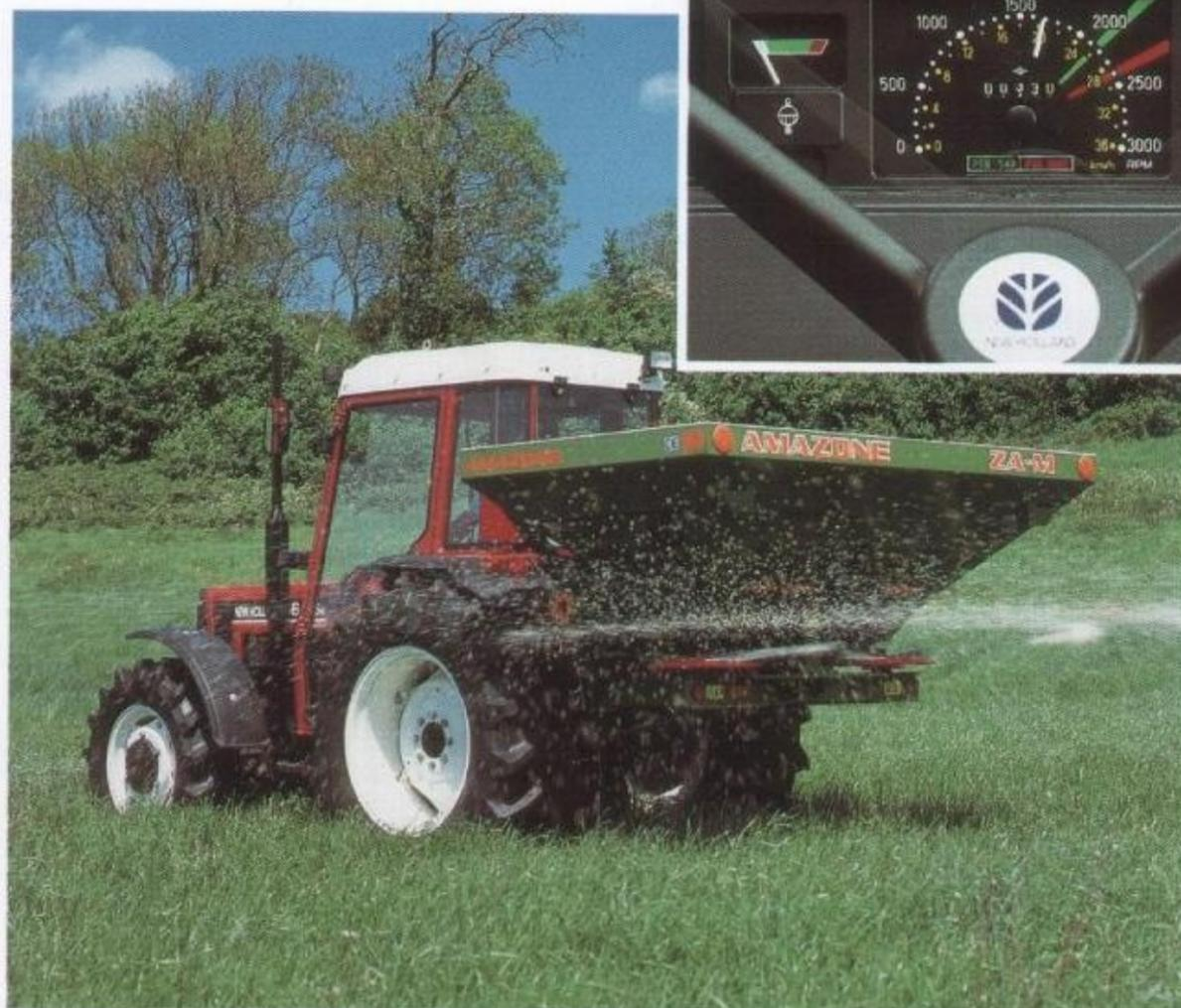
*La velocità PTO di 750 giri/min. consente la riduzione della velocità del motore per operazioni che non richiedono l'eccezionale potenza massima dei trattori Serie 66S, aumentando così l'economicità di funzionamento.*
