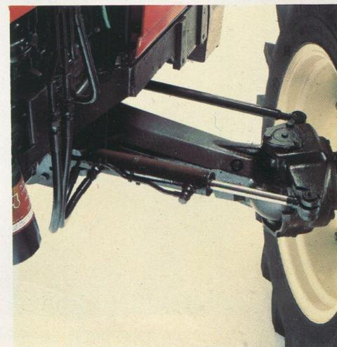
Version DT: Vue de dessous avec l'arbre de transmission coaxial.
