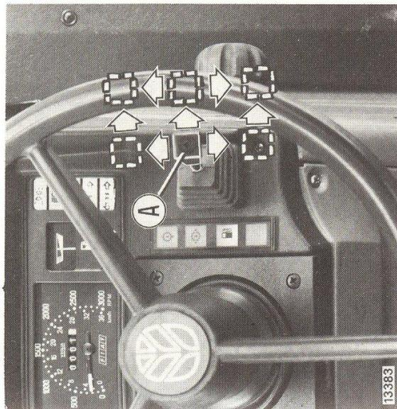
**A. Commutateur des feux de direction, éclairage en codes et en phares** (fonctionne avec commutateur **B** en position 1 page 20):
