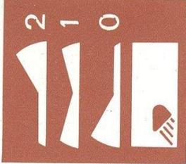
1 = Mise en circuit du projecteurs arrière du tracteur et des projecteurs de cabine avec leur témoin.
