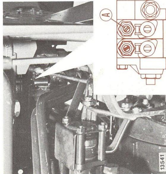
Dans l'utilisation à simple effet, pour repérer rapidement le raccord auquel l'outil doit être branché, actionner le levier du distributeur concerné et observer les deux tubes aboutissant aux raccords; le tube concerné par le passage de l'huile doit bouger.
