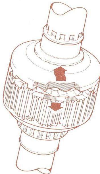
Le groupe NO SPIN, s'il est monté sur votre tracteur, se trouve à l'intérieur du carter support de la couronne conique du pont avant, à la place du différentiel conventionnel. Le NO SPIN, constitué essentiellement d'un groupe de manchons cannelés et d'anneaux dentés qui agissent comme un double joint à dents frontales à engagement et désengagement automatiques remplit les fonctions suivantes:
