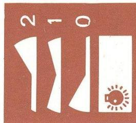
1 = Mise en circuit des feux de position et prédisposition pour projecteurs auxiliaires.
