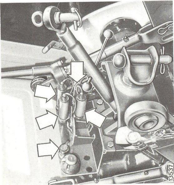
Un, deux, ou trois distributeurs auxiliaires qui utilisent la même huile que le relevage hydraulique, auquel ils sont accouplés, peuvent équiper le tracteur pour la commande à distance des vérins à simple et à double effet.
