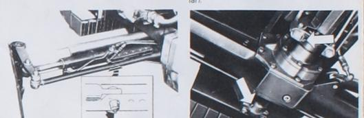
**22. HYDROSTATISK STYRNING (DT-version)** - Smörj med fett (två smörjnipplar).
