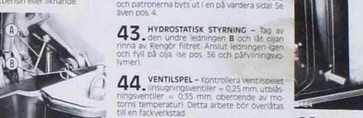
**44. VENTILSPEL** - Kontrollera ventilspellet i insugningsventilerna = 0,25 mm utbrensventilerna = 0,35 mm. Oberoende av torns temperatur. Detta arbete bör överlämnas till en fackverkstad.
