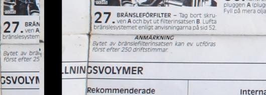
**27. BRÄNSLEFÖRFILTER** - Tag bort skruven A och byt ut filterinsatsen B. Lufta bränslesystemet enligt anvisningarna på sid 52.
