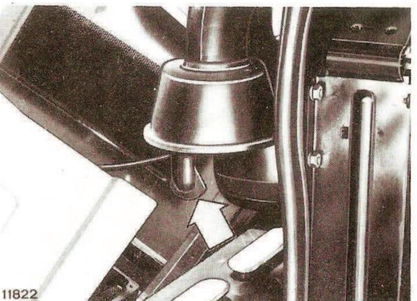
**2** FILTRO DE AIRE - Apriete el terminal de goma para verificar si está obstruida la válvula de descarga.
