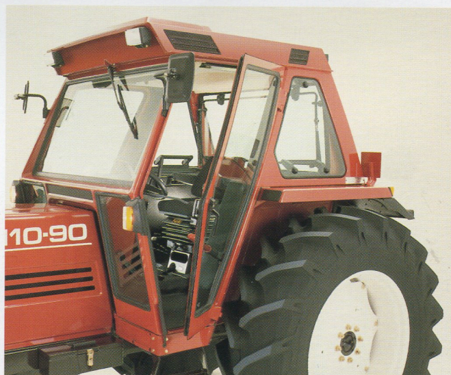
Cabine "SuperConfort" avec installation d'air conditionné.
