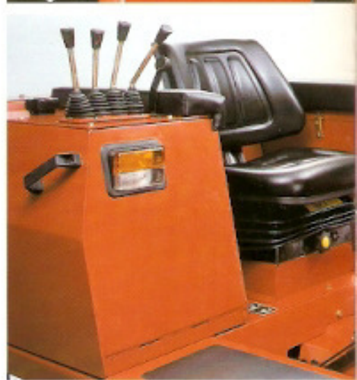
Posto guida con nuovo sedile a sospensione registrabile
