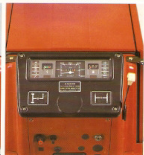
Quadro controllo strumentazione
