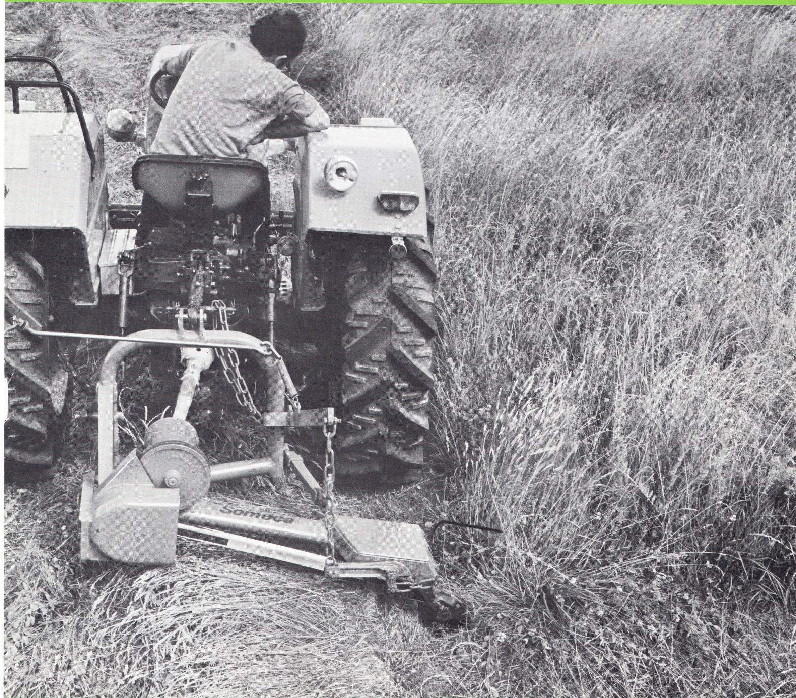
*La faucheuse K 27 portée arrière "3 points" se caractérise par une très grande simplicité conférant à l'ensemble à la fois robustesse et sécurité de fonctionnement. Elle s'adapte directement au relevage hydraulique de tous les tracteurs sans modification ou pièces spéciales.*
