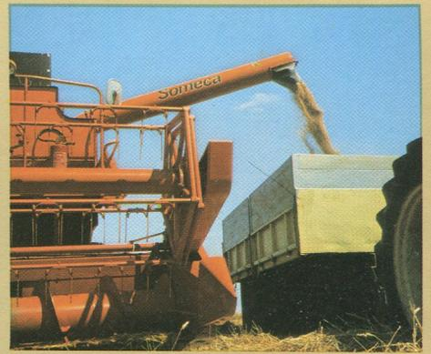
Les secoueurs à action tridimensionnelle assurent une parfaite aération du matelas de paille, donc une meilleure récupération des grains et un rendement accru de la machine.
