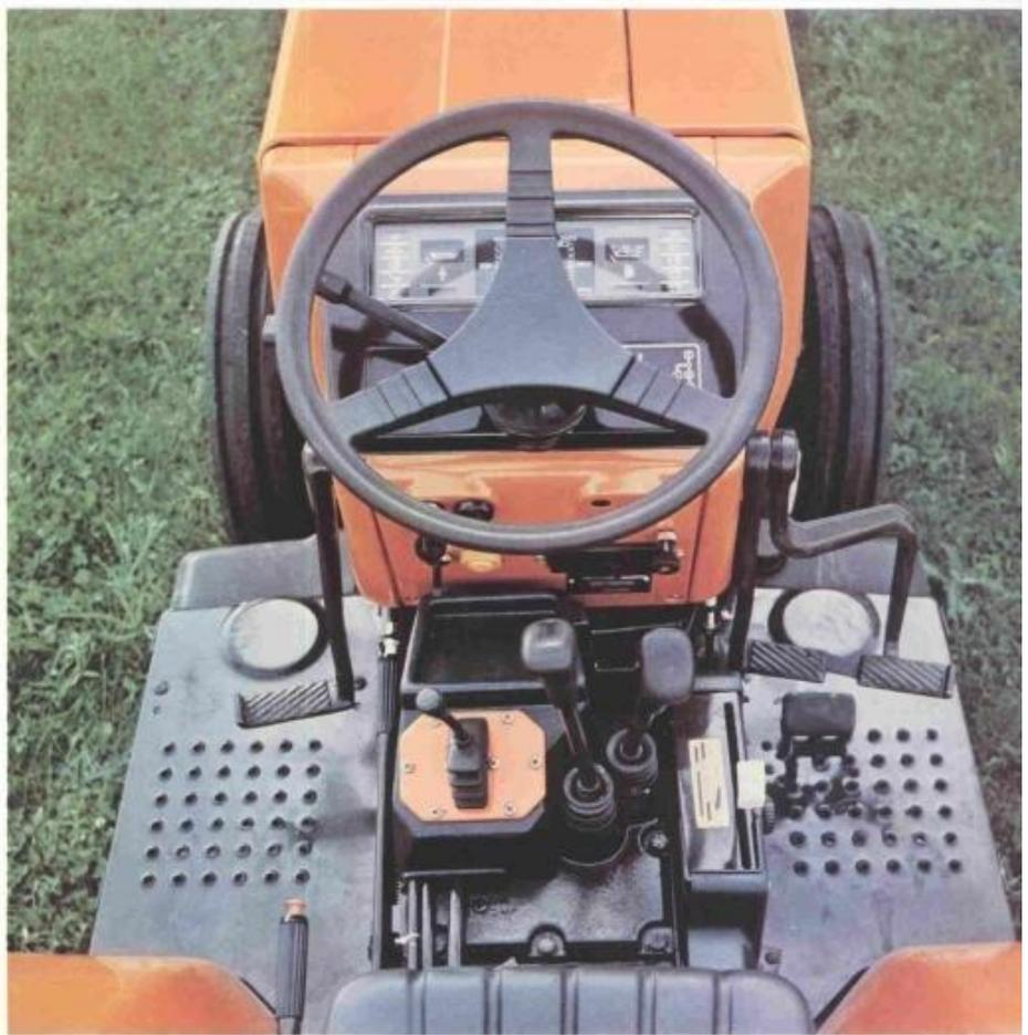
contrôlés ■ Débit de la pompe : 24,6 l/mn au régime nominal ■ Pression de tarage : 190 bars ■ Capacité de levage : 2 500 kg ou 2 000 kg ■ Réglage de la sensibilité par levier ■ Distributeur auxiliaire simple effet pour la commande de vérins à distance.
