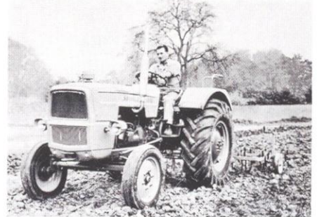
SOMECA 615 équipé d'un vibroculteur
