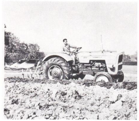
SOMECA 615 au labour équipé d'une charrue bisoc réversible
