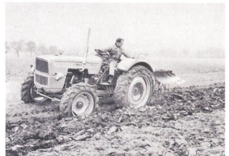
SOMECA 715 TD équipé d'une charrue trisoc réversible
