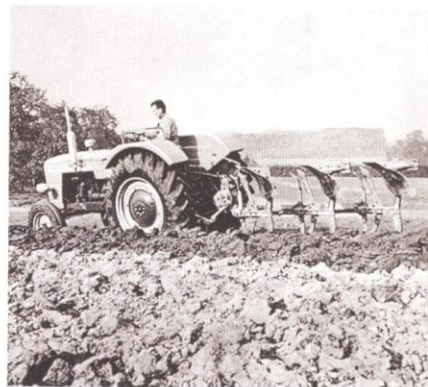
SOMECA 715 au labour équipé d'une charrue trisoc réversible
