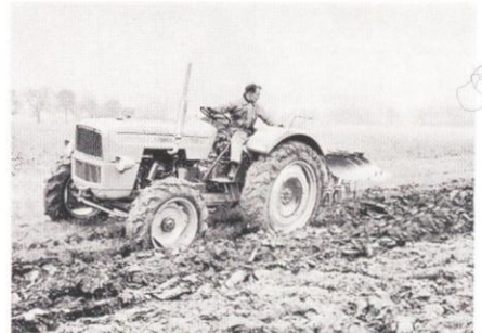
SOMECA 715 TD 5 L au labour équipé d'une charrue trisoc réversible
