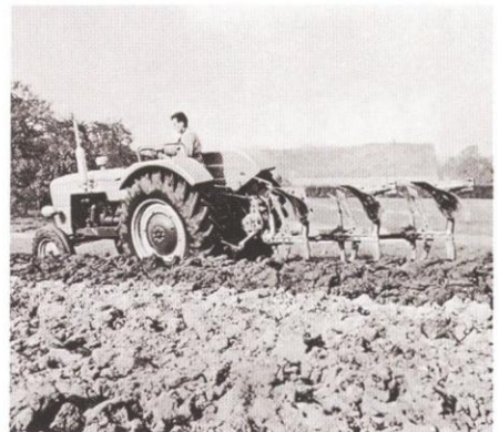
SOMECA 715 5 L au labour équipé d'une charrue trisoc réversible
