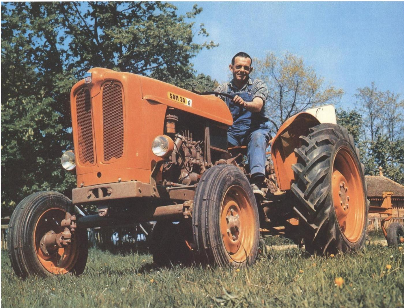
Le SOMECA SOM. 30 B (catégorie des 30 ch.) est le tracteur idéal de la moyenne exploitation agricole. Son relevage hydraulique à position et effort contrôlés lui permet de réaliser des performances supérieures à celles de tout autre tracteur de poids équivalent.
