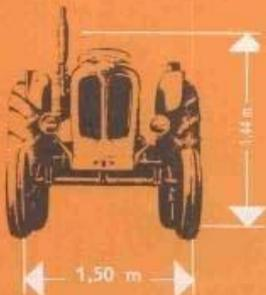
Le SOMECA SOM. 30 B (catégorie des 30 ch) est le tracteur idéal de la moyenne exploitation agricole. Son relevage hydraulique à position et effort contrôlés lui permet de réaliser des performances supérieures à celles de tout autre tracteur de poids équivalent.
